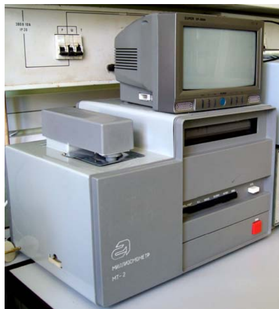
Рис. 4. Лазерный криоскопический видеомиллиосмометр на базе МТ-2. Конструкция и исполнение автора
